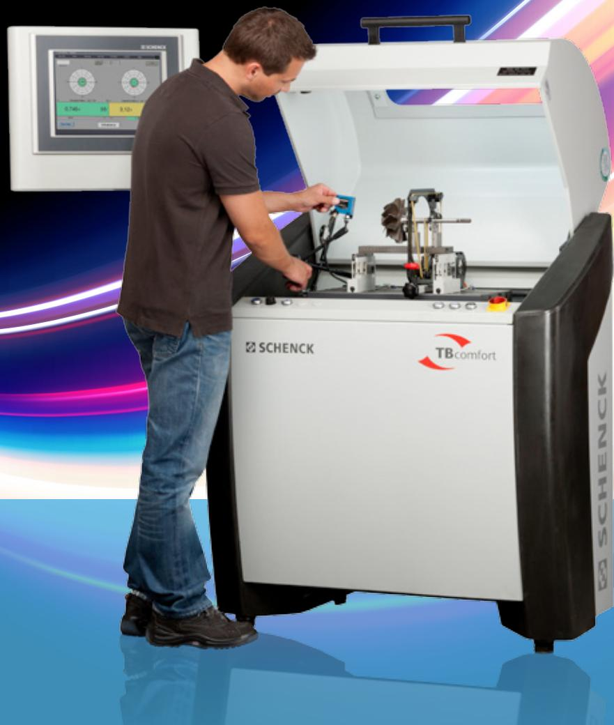
La **TBcomfort** est le point de départ pour une remise en état de qualité : dans un premier temps, le balourd initial est supprimé, ce qui est impératif pour un équilibrage haute vitesse. Cette étape est facilitée par l'ergonomie et la haute précision de la **TBcomfort**. Le système d'entraînement à étrier
