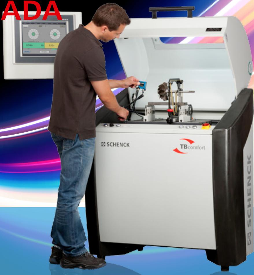
La **TBcomfort** crea la base para una reparación de alta calidad: en el primer paso se elimina el equilibrio original de los componentes y del cuerpo central montado. Esto crea el requisito para el equilibrado posterior a altas revoluciones. El uso simple y lógico de la **TBcomfort**, el diseño ergonómico de todo el sistema y el sistema de alta precisión facilitan el trabajo. Por ejemplo, con el montaje sencillo del rotor en la máquina gracias al cómodo
