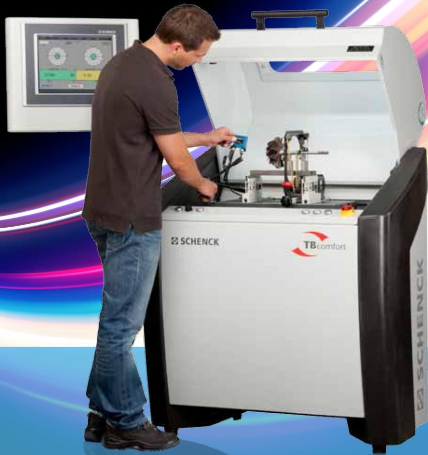
A **TBcomfort** cria a base para uma remanufatura de alta qualidade: elimina-se, num primeiro passo, o desbalanceamento inicial dos componentes, assegurando a montagem do rotor. Isso cria as condições necessárias para o posterior balanceamento em alta rotação. Este processo é realizado de forma simples e lógica na **TBcomfort**, que conta ainda com um projeto ergonômico e alta precisão.
